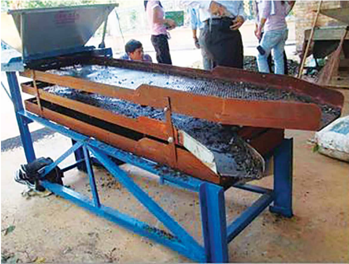
H9: Máy bóc vỏ, phân loại tiêu
